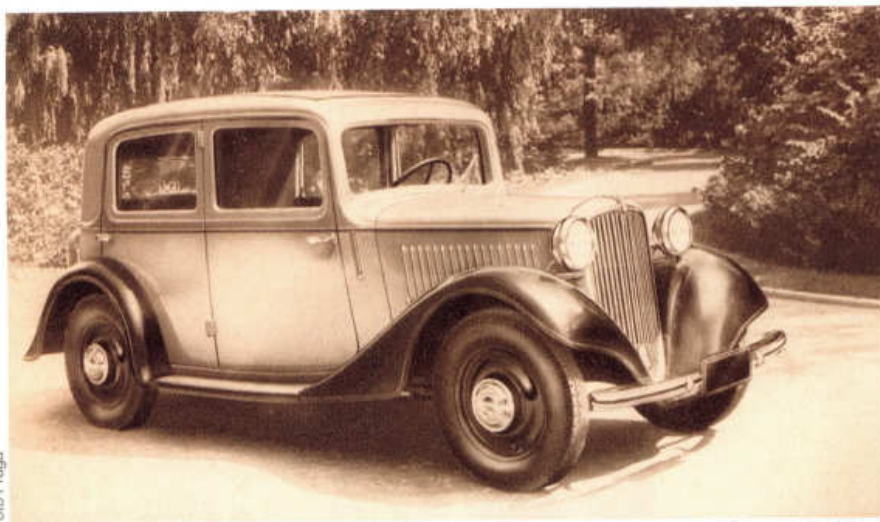
Praga Piccolo 1,0 I s novou prostornější karoserií, která nesla zvenku přístupný zavazadlový prostor (1934)
